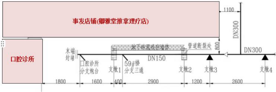
图 8 管道敷设及支墩示意图
