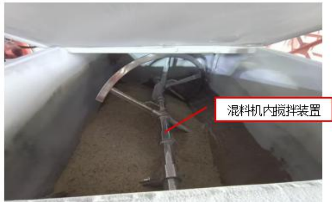
图 4 普混机混料仓搅拌装置
