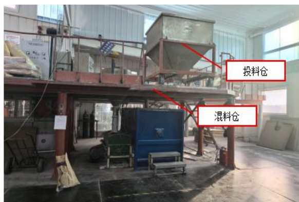
图 1 普混机中层投料仓、混料仓
